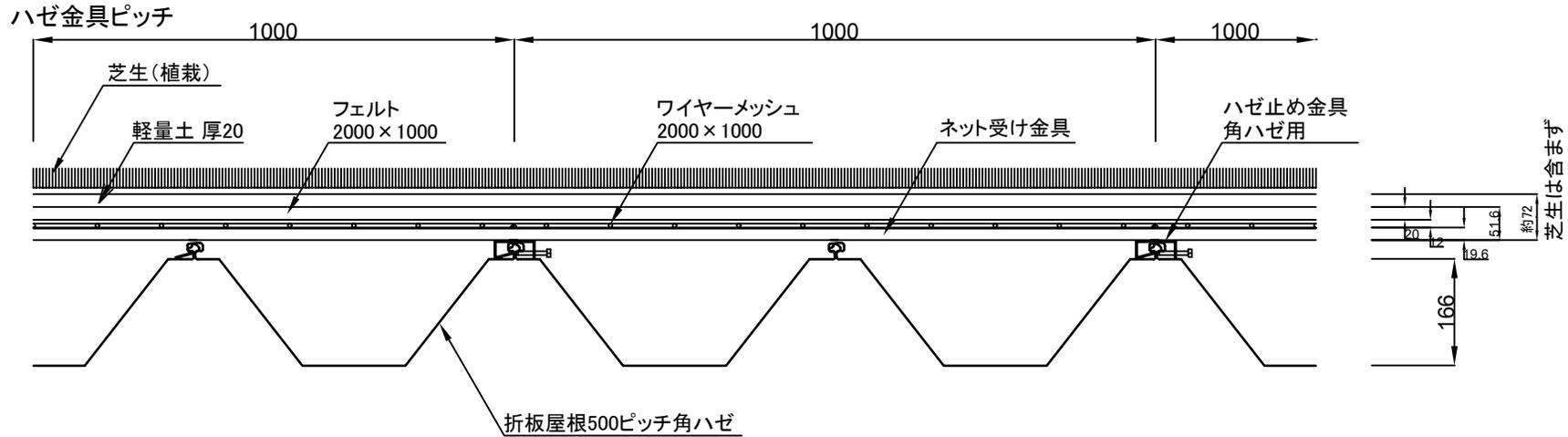
折板流れ方向基準断面
